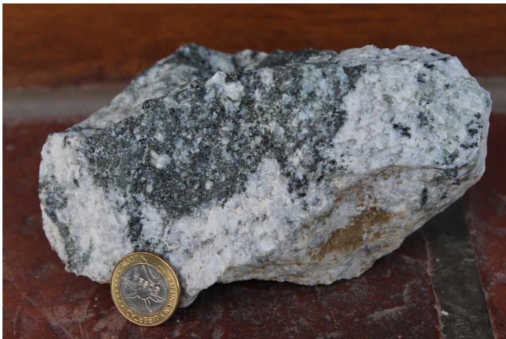
Figura3B. Muestra de mano. Se observa una textura granuda con cristales de feldespato alcalino, cuarzo y abundantes mafitos.
