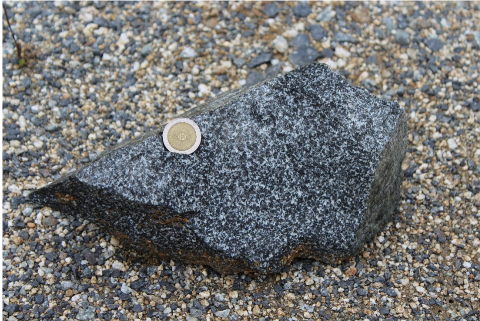
Figura 7. Granitoide del Cerro Tandileofú. Se observa una textura granuda con presencia de cuarzo, plagioclasa (andesina) y biotita.
