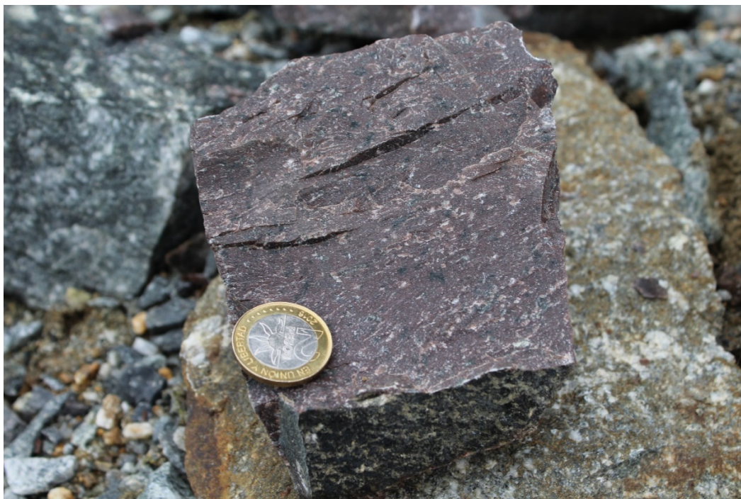
Figura 11A. Muestra de mano de dique riolítico. Se observan cristales de plagioclasa cuarzo y mafitos, rodeados por una pasta felsítica.
