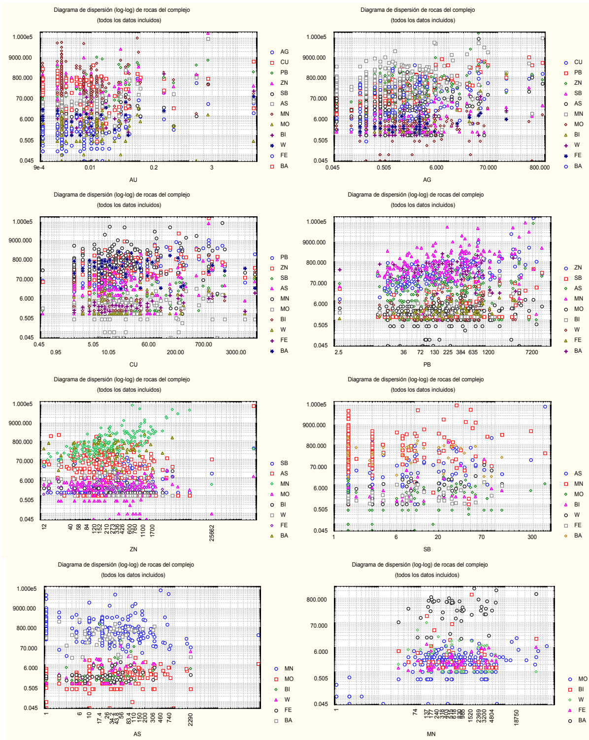
Fig. 5.17. Diagramas de dispersión múltiple con escala log-log de alteración hidrotermal del Complejo Volcánico Galán.
