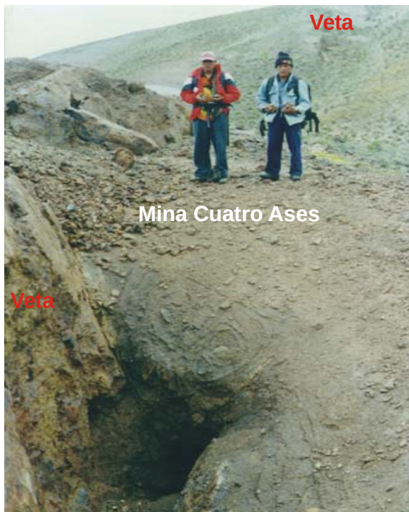
Fig. 4.55. Foto de la veta en la mina Cuatro Ases encajonadas en depósitos piroclásticos.
