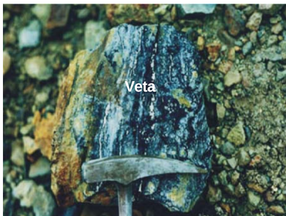
Fig. 4.18. Foto de veta en la sección Germania, que muestra textura bandeada.
