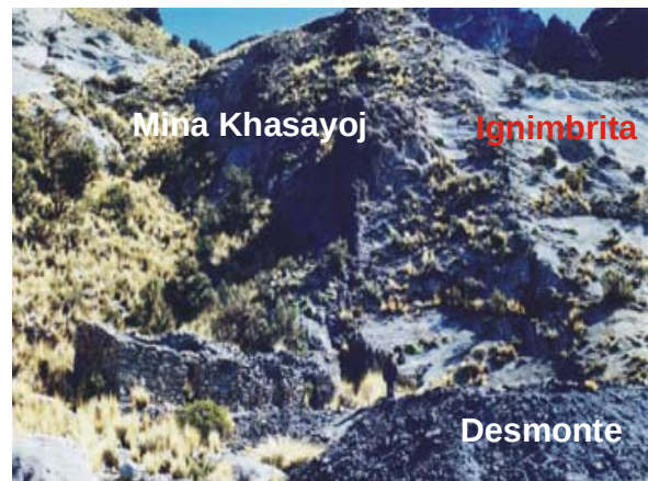
Fig. 4.38. Fotos de la veta que esta encajonada en la ignimbrita en la mina Khasayoj. En la parte inferior el desmonte.
