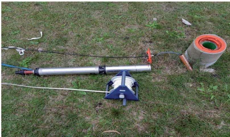
Figura 1. Bomba, sonda de nivel de agua y pozo de bombeo gw1.
