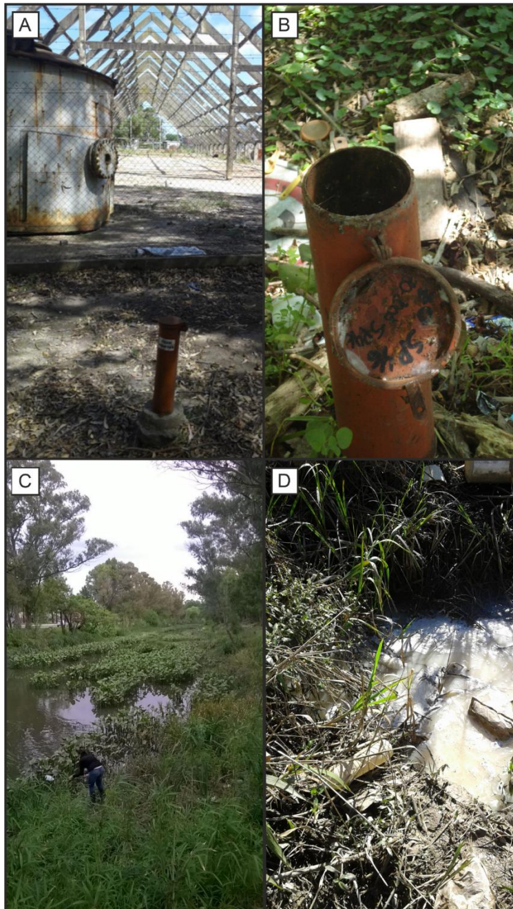
Figura 5. A. Estructura de la antigua fábrica de ácido sulfúrico de fondo y freatímetro desde donde se tomó una de las muestras de agua subterránea. B. Freatímetro desde donde se tomó una muestra de agua subterránea. C. Toma de muestras de agua superficial mediante el uso de botellas plásticas. D. Descarga de efluente en el Canal Este.
