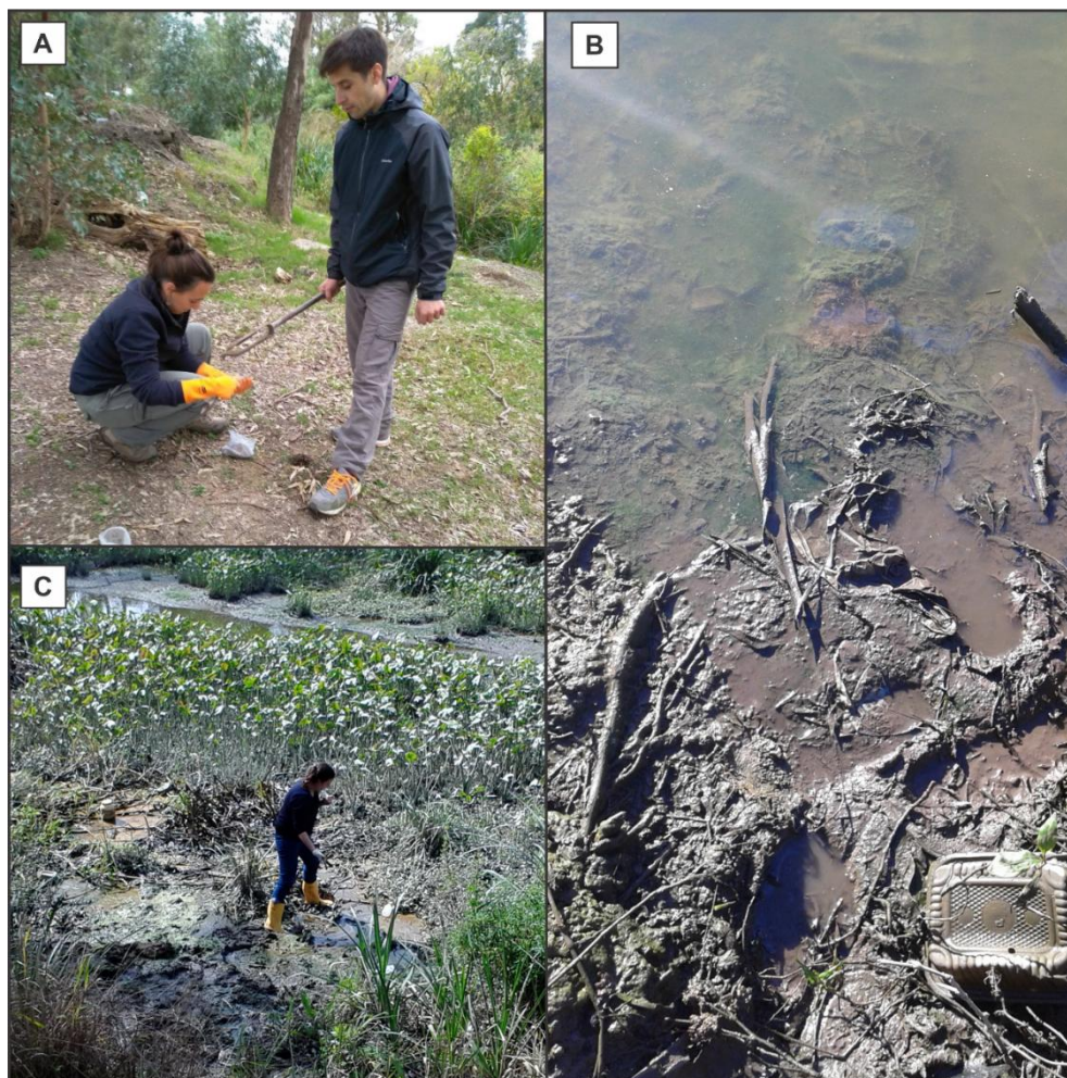
Figura 3. A. Toma de muestra de sedimentos con barreno manual, zona entre la antigua fábrica de ácido sulfúrico y la bajada al Canal Este. B y C. Recolección de sedimentos en el cauce del Canal Este.
