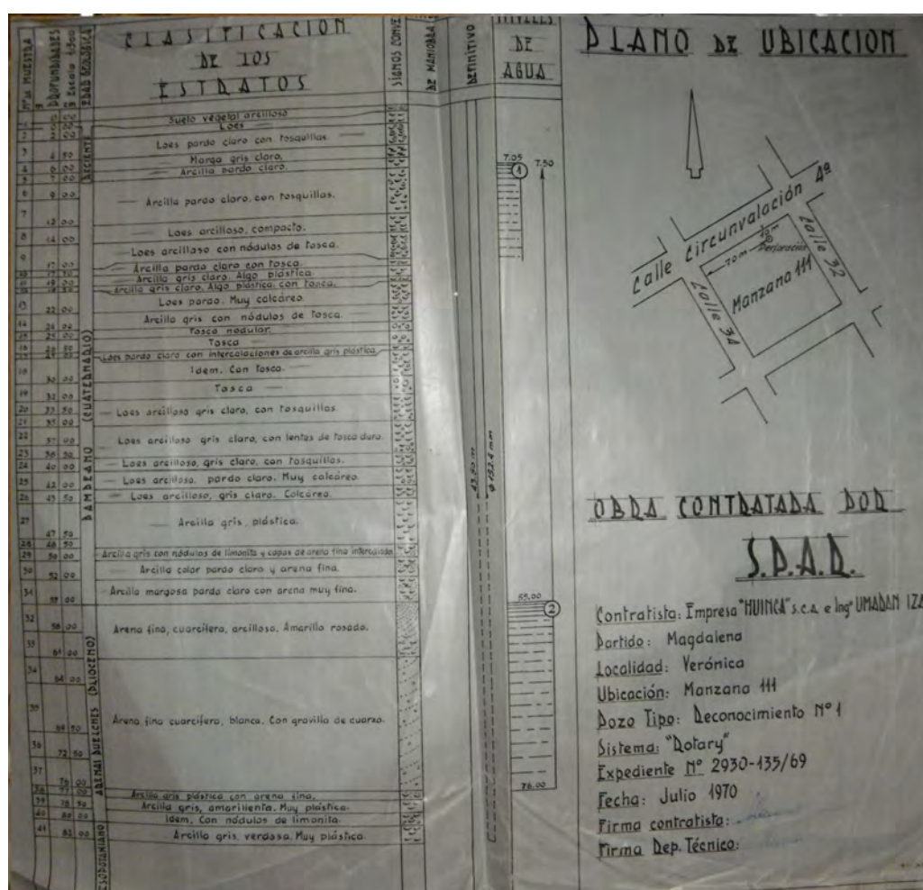
Figura A.6: Registro pozo de explotación para la localidad de Verónica. Realizado por el SPAR
