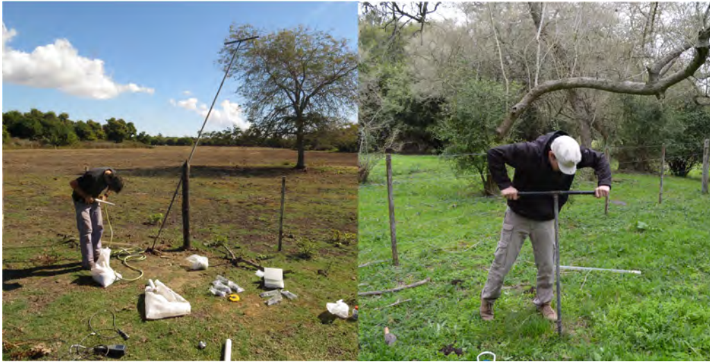
Figura 4.1: Realización de perforaciones someras mediante barreno manual.
