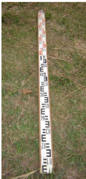
Figura IV 4. Mira estadimétrica telescópica de madera invertida. La menor graduación de la mira es un centímetro.
