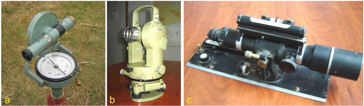
Figura IV 5. a) Brújula taquimétrica montada sobre trípode. b) Teodolito Wild T1. c) Antigua alidada Gurley.
