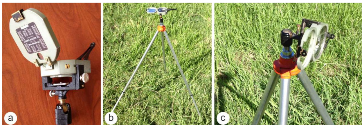
Figura V 23. a) Soporte articulado para brújula Brunton. b) La Brunton sobre trípode en posición para medir acimuts. c) La Brunton con soporte acodado para medir ángulos verticales.
