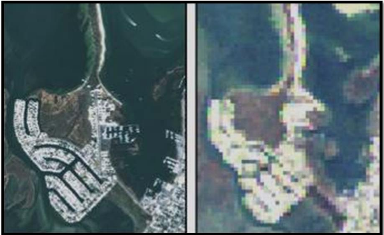
Figura XIV 1. Información raster. Imágenes satelitales con diferente resolución espacial. En la imagen derecha puede apreciarse que a esa escala pueden distinguirse fácilmente los píxeles que conforman la imagen.
