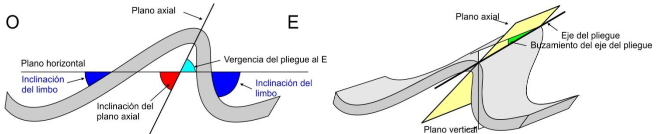
Figura XVIII 2. Partes de un pliegue y elementos a medir.
