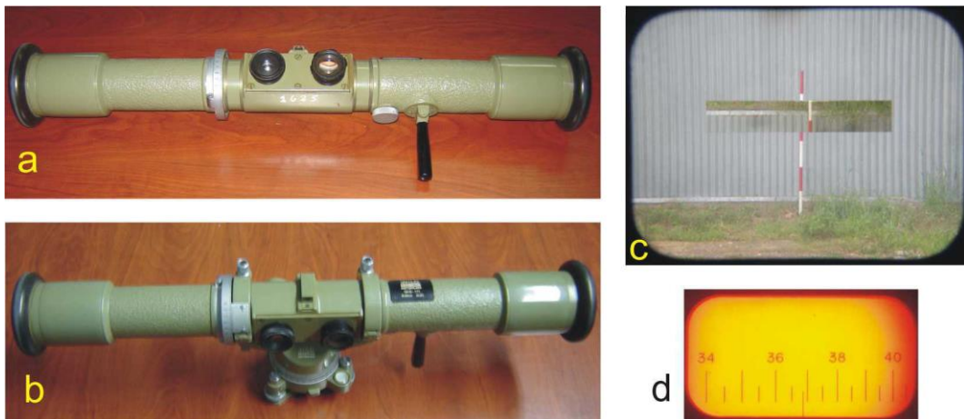
Figura IV 3. a) Telémetro marca Wild para medir distancia entre 30 y 1000 m. b) Telémetro acoplado al soporte que permite montarlo sobre un trípode. c) Imagen que se ve a través del ocular, la ventana rectangular interior entrega una imagen invertida del mismo objeto vertical (un jalón en el ejemplo) que debe llevarse a coincidencia con la imagen mayor. d) Escala de distancia.
