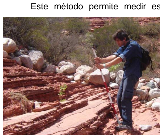
Figura XVII 3. Midiendo espesores de rocas sedimentarias con el báculo de Jacob y brújula Brunton.
