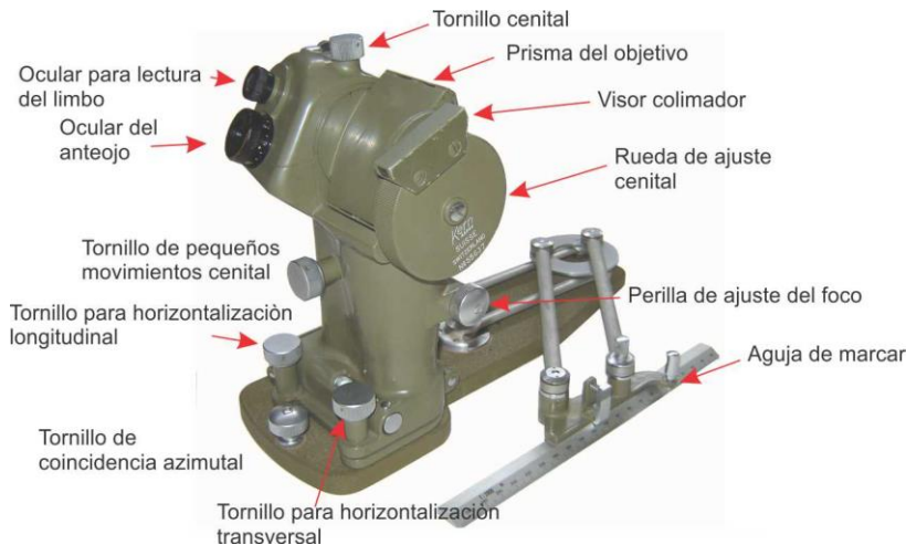
Figura X 4. Alidada autorreductora Kern Aarau RK 360.
