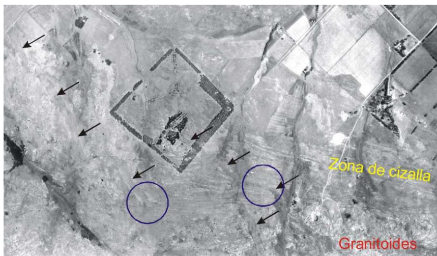
Figura XII 16. Zona de basamento cristalino de los alrededores de la Ciudad de Tandil conformado por granitoides cortados por una zona de cizalla y diques de diabasa (flechas). Los diques al cortar la zona de cizalla se desvían de su rumbo NNO disponiéndose paralelos a aquella (círculos). En ancho de la fotografía abarca unos 3,5 km.
