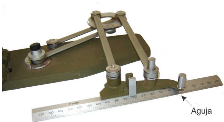
Figura X 7. Regla de escala 1:5.000 de la alidada Kern.
