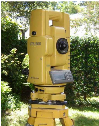
Figura VIII 13. Estación total TOPCON GTS300.
