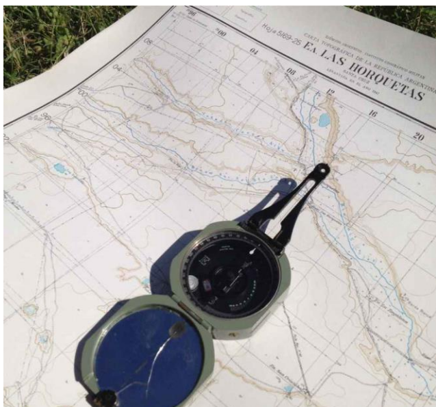
Figura V 18. Orientando el mapa en el campo. El borde de la brújula coincide con el norte magnético (en este caso igual al norte de la cuadrícula) y la punta de la aguja está marcado acimut 0^\circ .
