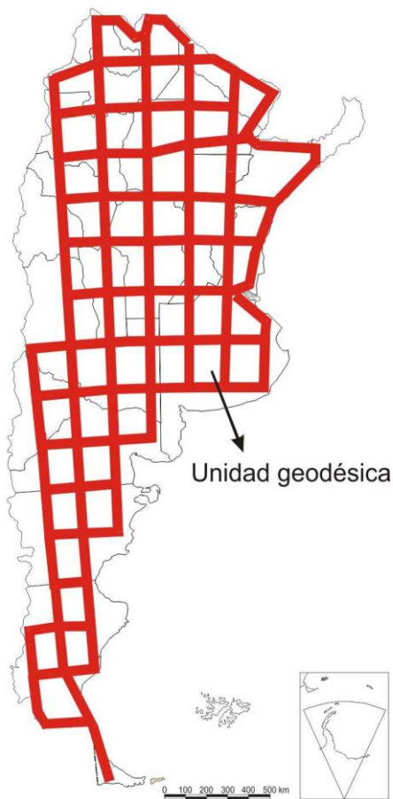
Figura I 19. Red fundamental de triangulación.
