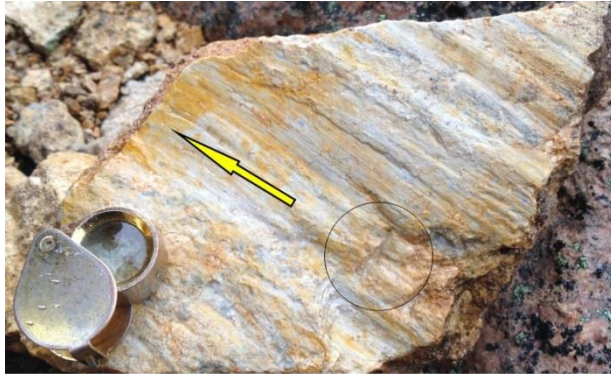
Figura XVIII 11. Espejo de falla con estrías y escalones que indican el sentido y dirección del desplazamiento de la falla.
