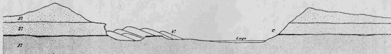
Fig. 10. Perfil esquemático de la excavación de El Puntudo. 1°. 2°. 3°. mantos eólicos superpuestos, 4°. médanos actuales, c. cenizas andesíticas. —
