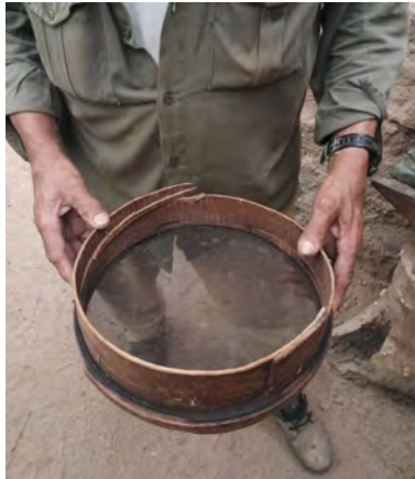
Figura 6.16. Zaranda utilizada para tamizar la molienda de la algarroba.
