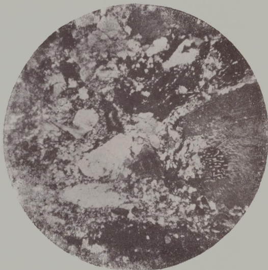
Fot. № 14. Muestra № 40. — Milonita de granito . Los minerales de la roca han sido parcialmente destruidos por acción tectónica construyendo los restos una masa granular, intersticial, con aspecto de corriente. C. A. x 11.
