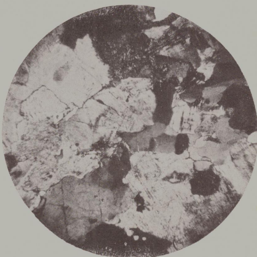
Fot. № 2. — La misma preparación, con analizador. Se aprecia la extinción ondulada del cuarzo y las áreas de ataque mirmekítico, con formación de plagioclasa y cuarzo vermicular. x 32.
