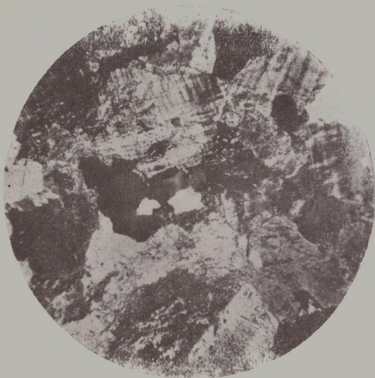
Fot. № 13. Muestra № 64. Granito . Microclino predominante, poco cuarzo, con extinción ondulada. La plagioclasa se halla muy alterada. C. A. x 11.
