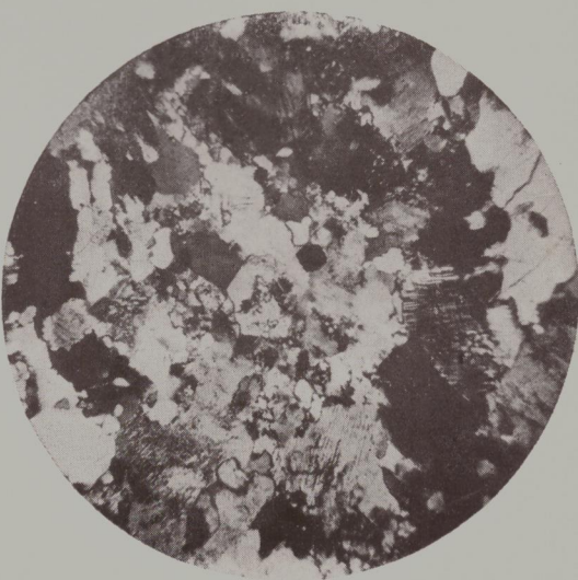
Fot. № 4. — Muestra № 48. — Granito. Roca de grano fino, los minerales poseen sus bordes irregulares, especialmente el cuarzo y el microclino. C. A. x 32.
