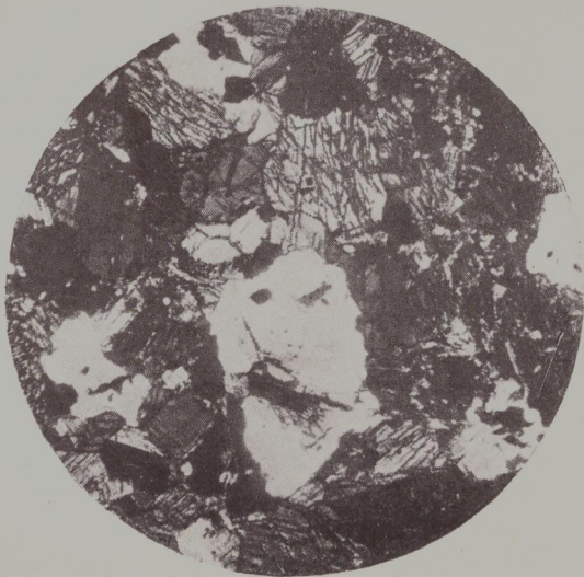
Fot. № 16. Muestra № 67. Ortoanfibolita . Secciones de hornblenda parcialmente destruidas; en el centro plagioclasa agrietada. El cuarzo es muy escaso. S. A. r 11.
