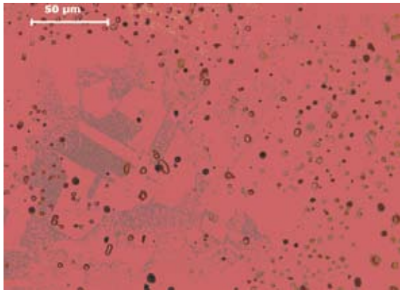
Figura 7. Microestructura de trabajado y recocido en el fragmento del sector vecino a la boca. Se observan granos de recristalización con maclas de recocido en su interior (zonas delimitadas por bordes rectos). Los puntos negros son restos de pátina.
