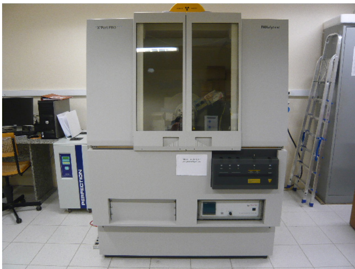
Figura 164: Difractómetro de la marca X'Pert Pro MPD – Panalytical del Laboratorio de Rayos-X de la UFC. Fuente: http://www.raiosx.ufc.br/site/?page_id=286
