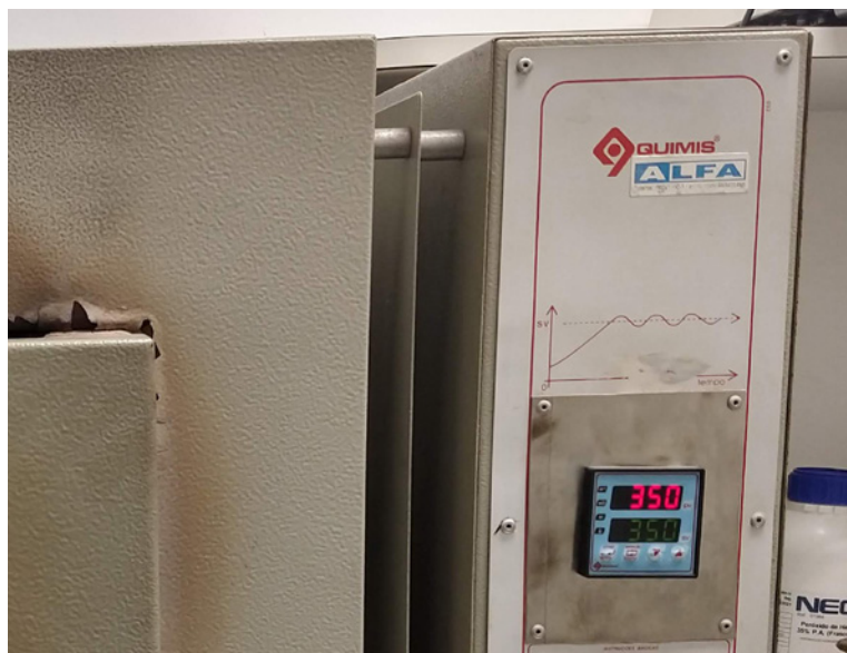
Figura 56: Horno químico utilizado en la experimentación de cocción cerámica. A la derecha panel de control de la temperatura interna del horno (en el momento estaba en 350°C).
