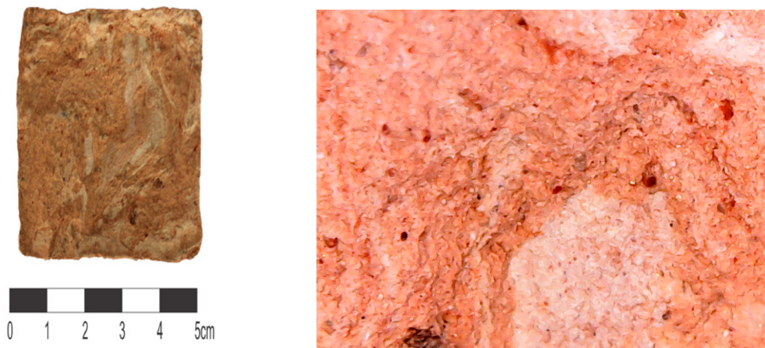
Figura 148: Cerámica experimental Ar2, con destaque de la pasta no uniforme con un aumento de 10x (Sacado de Bysameyee Microscópio digital USB).
