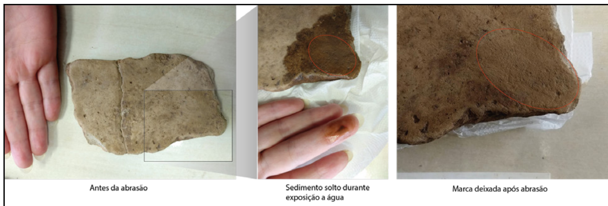
Figura 87: Secuencia de fotografías que demuestran la friabilidad de una cerámica del Lago Rico al ser expuesta al agua. Resaltamos con un círculo rojo la zona donde tenemos la abrasión con el dedo, después de haber mojado la muestra. Ver la secuencia de izquierda a derecha.
