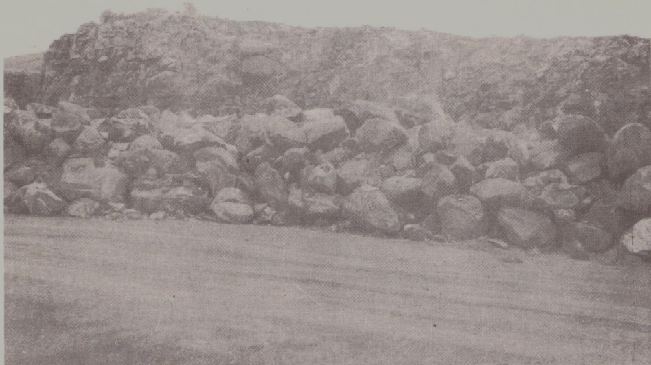
Foto 2.— Detalle de los bochones apilados para trituration en la cantera La Garrapata.
