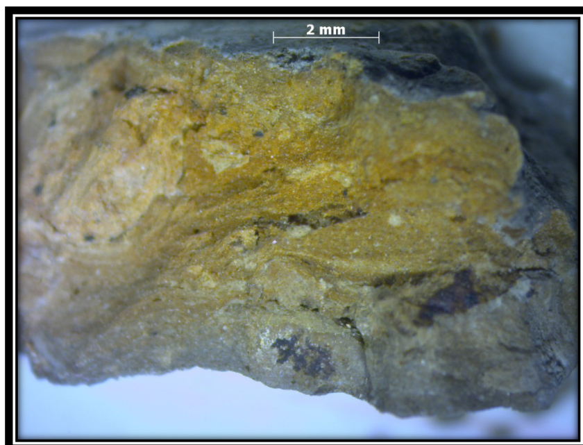
Figura 6.16. Fragmento perteneciente a estándar E, visto en lupa binocular (20-40 x aumentos). Con una matriz compacta de tonalidades que varían de pardo a naranja. Presenta litoclastos de colores grises y pardos, angulosos de tamaños medianos a grandes. Fragmento SChasmar 1.1 P5N4-327.
