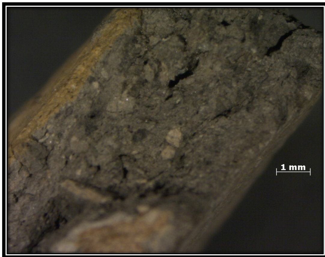
Figura 5.18. Fragmento perteneciente a estándar 7, visto en lupa binocular. Se presenta la matriz porosa con tonalidades naranja a naranja rojizo. Fragmento SForMat 1-1 RS 139.
