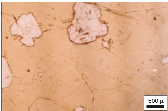
Fig. 3-79. Fotomicrografía de obsidiana riolítica donde se observan cristales de feldespato en una pasta vítrea con incipiente textura perlítica.
