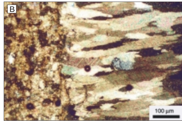
Fig. 4-29 A y B. Bandas de calcita de tipo A (a la izquierda de la foto), sin y con nicoles cruzados, respectivamente.
