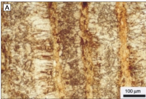
Fig. 4-30 A y B. Intercalación de bandas de tipo B y A, sin y con nicoles cruzados, respectivamente.
