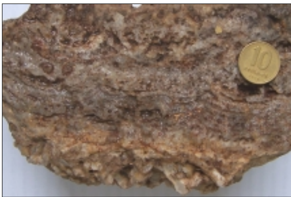
Fig. 4-93. Bandeado de cuarzo y sulfuros oxidados de la veta María Belén.
