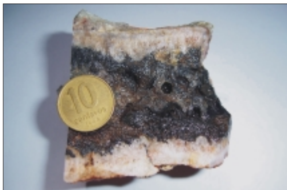
Fig. 4-96. Vetilla de cuarzo blanco con cuarzo gris oscuro en el centro.
