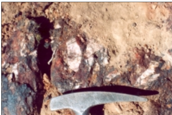
Fig. 4-60. Brecha compuesta por fragmentos de veta con cemento de óxidos de Fe y Mn.
