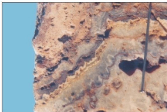
Fig. 6-1. Detalle de textura bandeada en una venilla de cuarzo del sector Veta Norte (TR 4).
