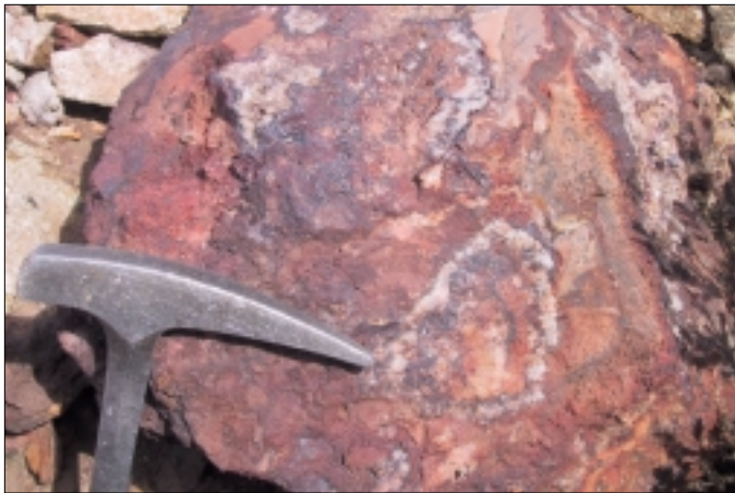
Fig. 4-88. Detalle de los pulsos de mineralización ricos en oro nativo, especularita y pirita de la veta Ailín.
