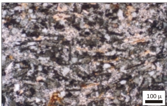
Fig. 3-103. Microfotografía de la textura pilotáctica de la pasta de las rocas dacitas.
