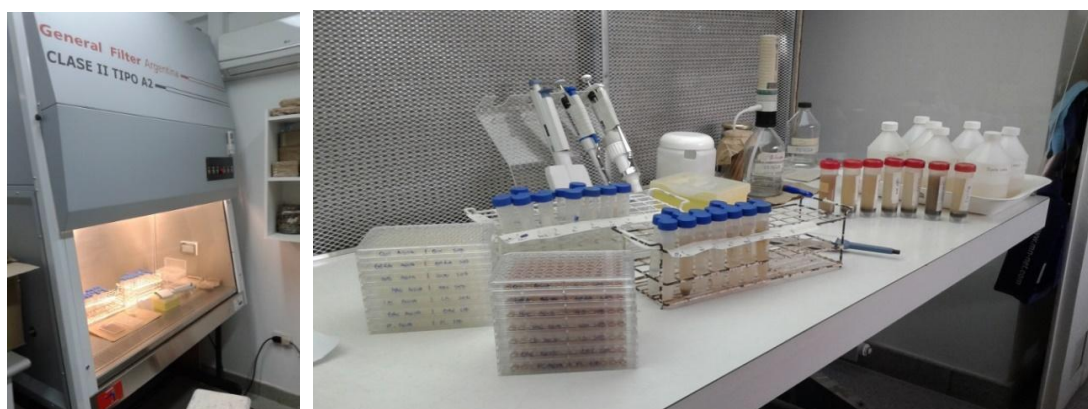
Figura 3.15. Cabina de bioseguridad Clase 2 (izq.) e imagen de las microplacas y las diluciones de las muestras (der.)
