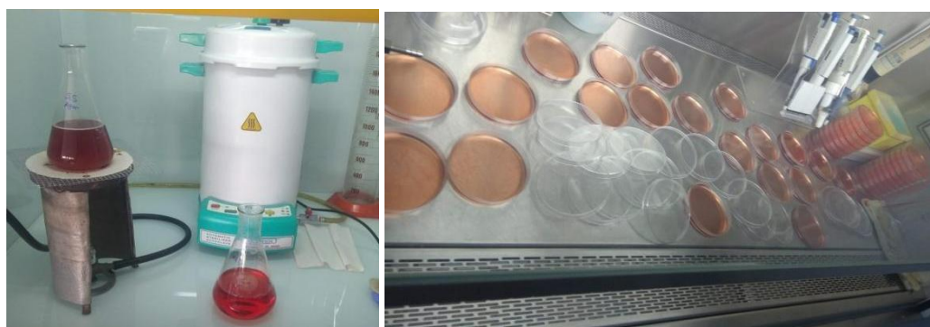
Figura 3.27. Preparación de los medios selectivos (izq.) y plaqueo de los mismos en una cabina de bioseguridad (der.)
