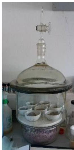
Figura 3.21. Vista general del desecador con las cápsulas en su interior.
