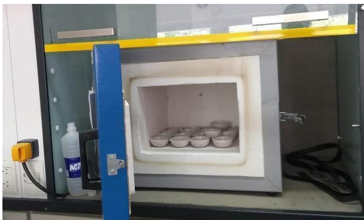
Figura 3.20. Mufla con las cápsulas de porcelana dentro.
