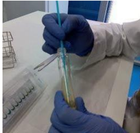
Figura 3.32. Preparación de la suspensión bacteriana a partir de la colonia típica seleccionada en los medios selectivos.
