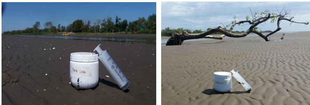
Figura 3.5. Sacabocados para la extracción de las submuestras y recipiente donde se incorporaron en una muestra compuesta. Playa PL (izq.) y MAG (der.)
