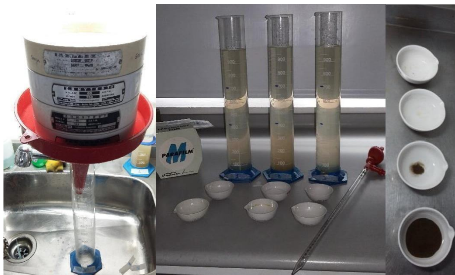
Figura 3.22. Los cuatro tamices sobre el embudo y la probeta para cada muestra (izquierda); Tres muestras con las probetas enrasadas a 1L con el material dispersante y la fracción de finos de la muestra (centro), y cápsulas con las cuatro fracciones de sedimento (derecha): Arena muy fina (abajo), Arena Fina, Arena media y Arena Gruesa (arriba).
