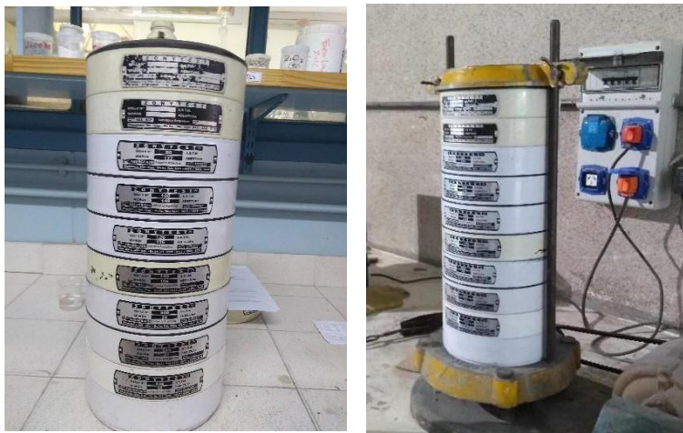
Figura 3.23. Nueve tamices con la base y la tapa (izq.) y los tamices ya asegurados a la plataforma vibratoria (der.).
