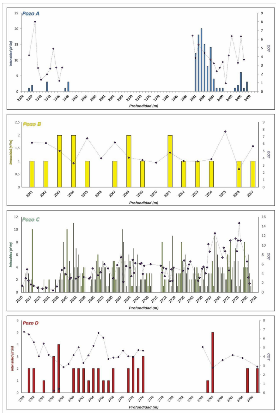
Figura 30. Diagramas de Intensidad y COT vs. Profundidad para los cuatro pozos estudiados.
