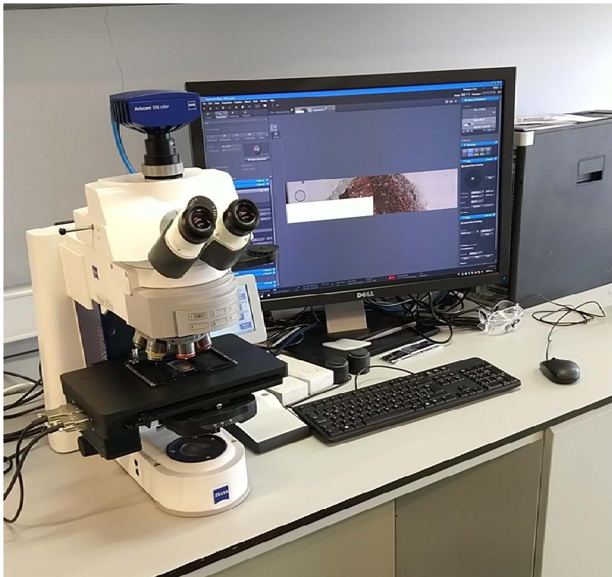
Figura 8. Microscopio Zeiss M2m en donde se realizaron los estudios petrográficos.
