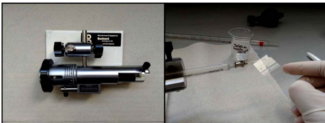
Fig. 3-9. Microaplicador manual Burkard® utilizado para la exposición por vía tópica.
