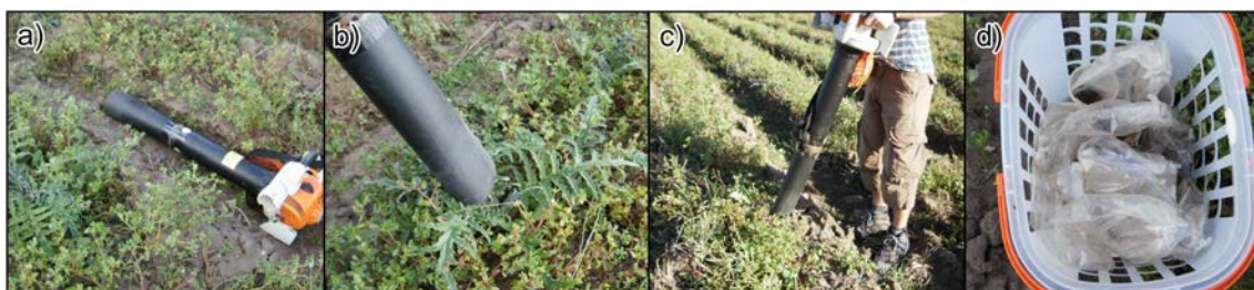
Fig. 2-8. Método del aspirador o G-Vac. a) aspirador, b) y c) posición utilizada para realizar la aspiración, d) bolsas individuales conteniendo cada aspiración por separado.
