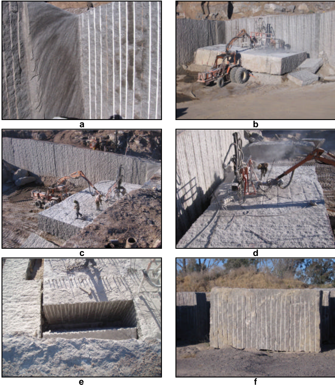
Figura 2. Principales etapas de la producción de bloques de granito en la cantera Galasur S.A.: a) corte de bloques, b) separación y vuelco, c-d-e) recuadre, f) bloque terminado.
