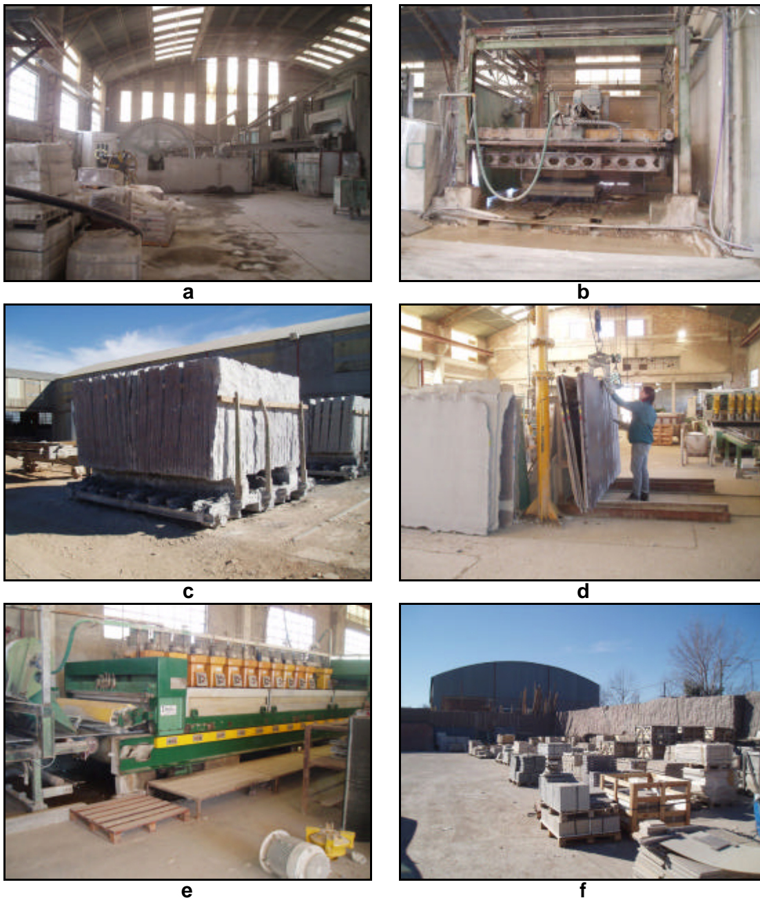
Figura 3. Elaboración de chapas y baldosas de granito en el aserradero de Marmolería Sierra Chica S.A.: a y b) corte en telar, c-d) chapas terminadas e) lustrado de chapas y baldosas, f) materiales terminados, listos para su comercialización.
