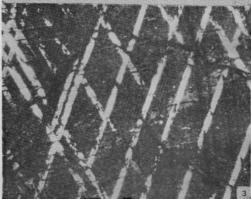
Fig. 2. Estructura concrecional de una espina. Cerro Pululus, Jujuy. c-casiterita, h-hematita. x30.
