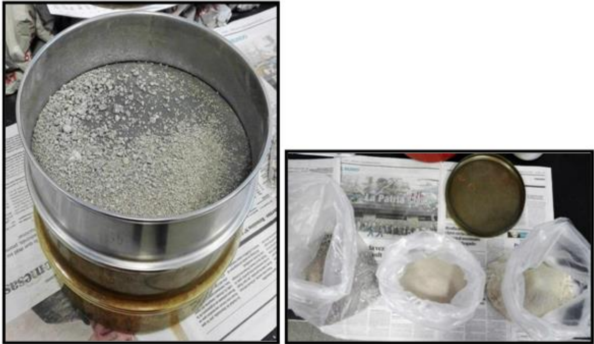
Fig 4.3.1: Foto de los tamices y las fracciones resultantes en el Laboratorio de Molienda (CIG-CONICET-UNLP).
