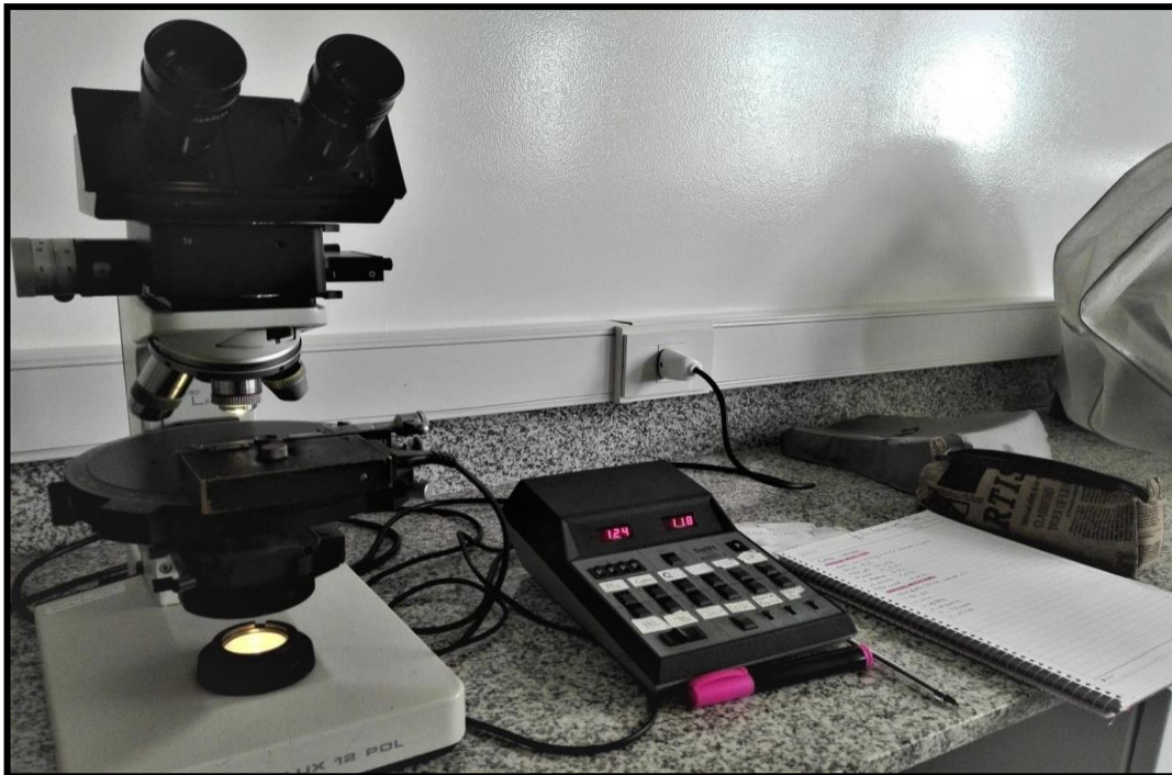
Fig 4.2.2: Equipo utilizado para el conteo de puntos de cada corte delgado (CIG-CONICET-UNLP).
