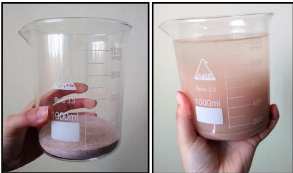
Fig 4.3.2: Representación del lavado de la fracción más fina de muestra en el vaso de precipitados.
