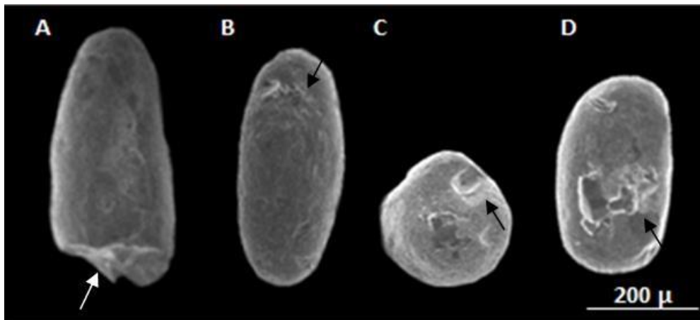
Fig 6.2.2.5: Marcas de superficie indicadas mediante flechas. A) Fracturación, B) Marcas de colisión, C y D) Delaminaciones de los cristales.
