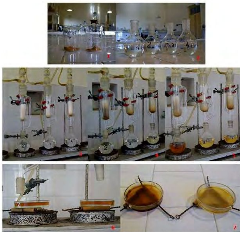
Figura 3. Secuencia de extracción de solubles en alcohol-benceno. Foto 1: madera a analizar. Foto 2: mezcla alcohol etílico 95% - tolueno (1:2) en balones de extracción. Fotos 3 a 5: dedales para extracción con aserrín molido dentro de extractores Soxhlet conectados a balones de extracción; distintas etapas del proceso. Foto 6: evaporación de solventes sobre plancha calefactora. Foto 7: residuos obtenidos (extraíbles).
