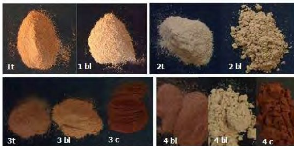
Figura 1. Muestras de aserrín de las maderas bajo análisis químico (Norma TAPPI); t: testigo; bl: pudrición blanca; c: pudrición castaña. Foto 1: roble europeo. Foto 2: ciruelo de jardín. Foto 3: paraíso. Foto 4: eucalipto.
