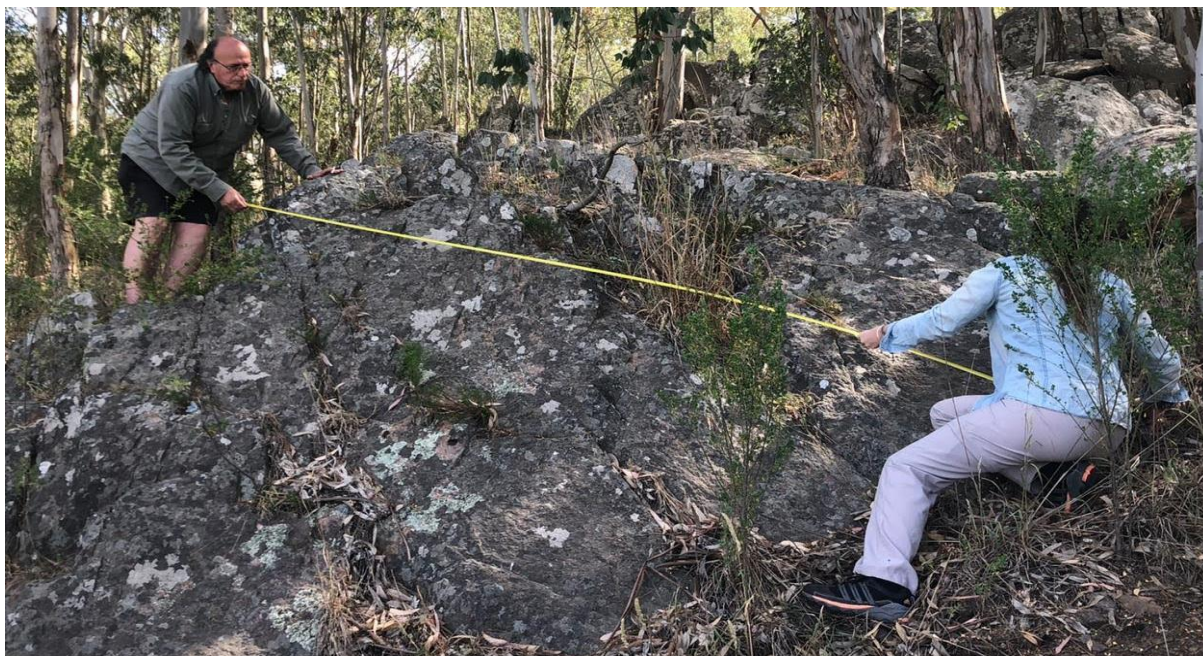
Figura 26.- Parte del afloramiento caracterizado en el margen de la presa del Arroyo del Fuerte. La medición que se observa, se realiza perpendicular al rumbo de la familia 3 de discontinuidades.
