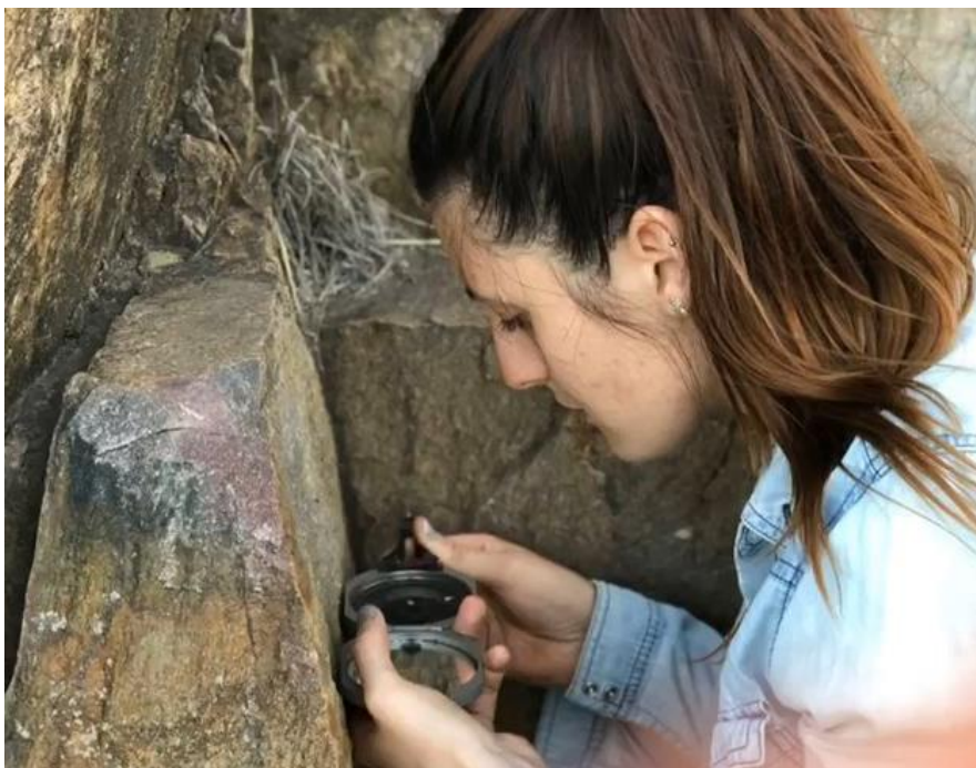
Figura 28.- Detalle de la medición de la orientación de un plano de discontinuidad.
