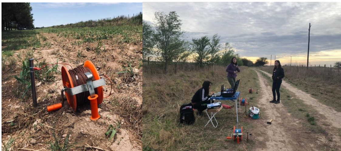
Foto 12. Campaña de sondeos eléctricos verticales (SEV).
