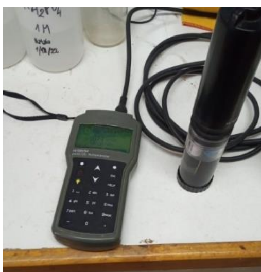
Foto 10. Determinación de pH y conductividad eléctrica con sonda multiparamétrica Hanna HI 9828.
