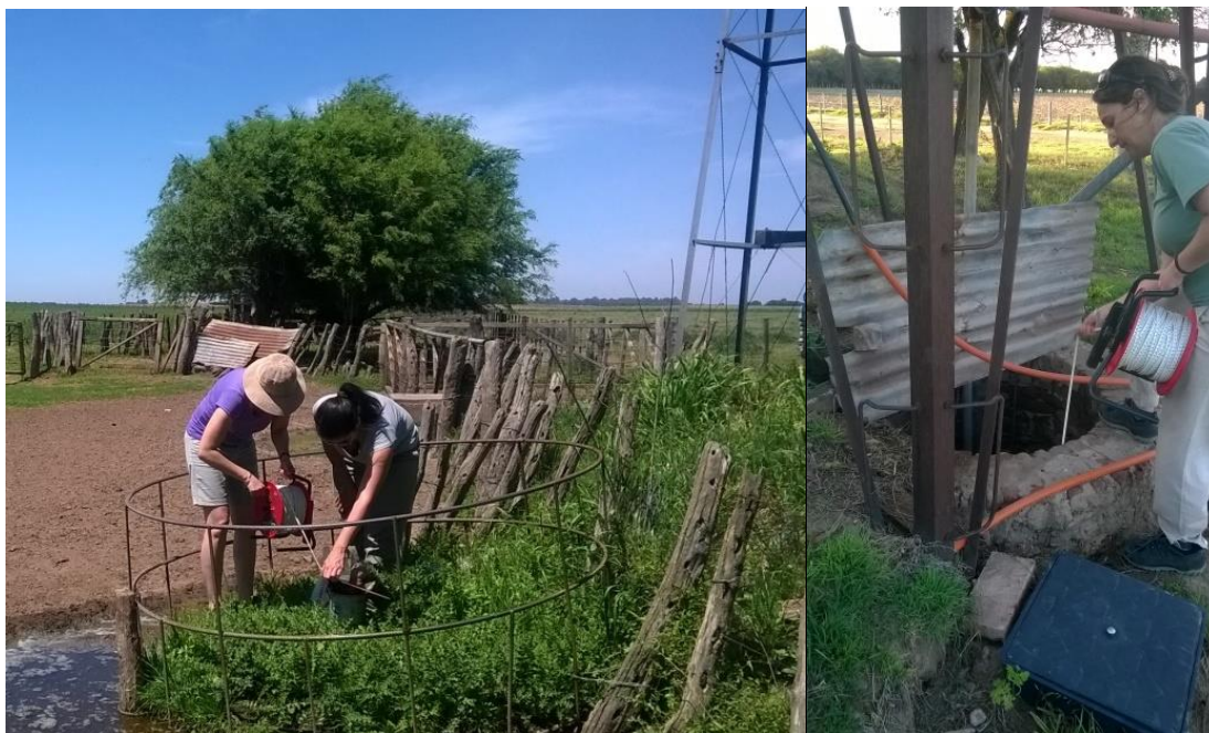
Foto 6. Medición de nivel estático durante las campañas de campo realizadas en noviembre de 2019.
