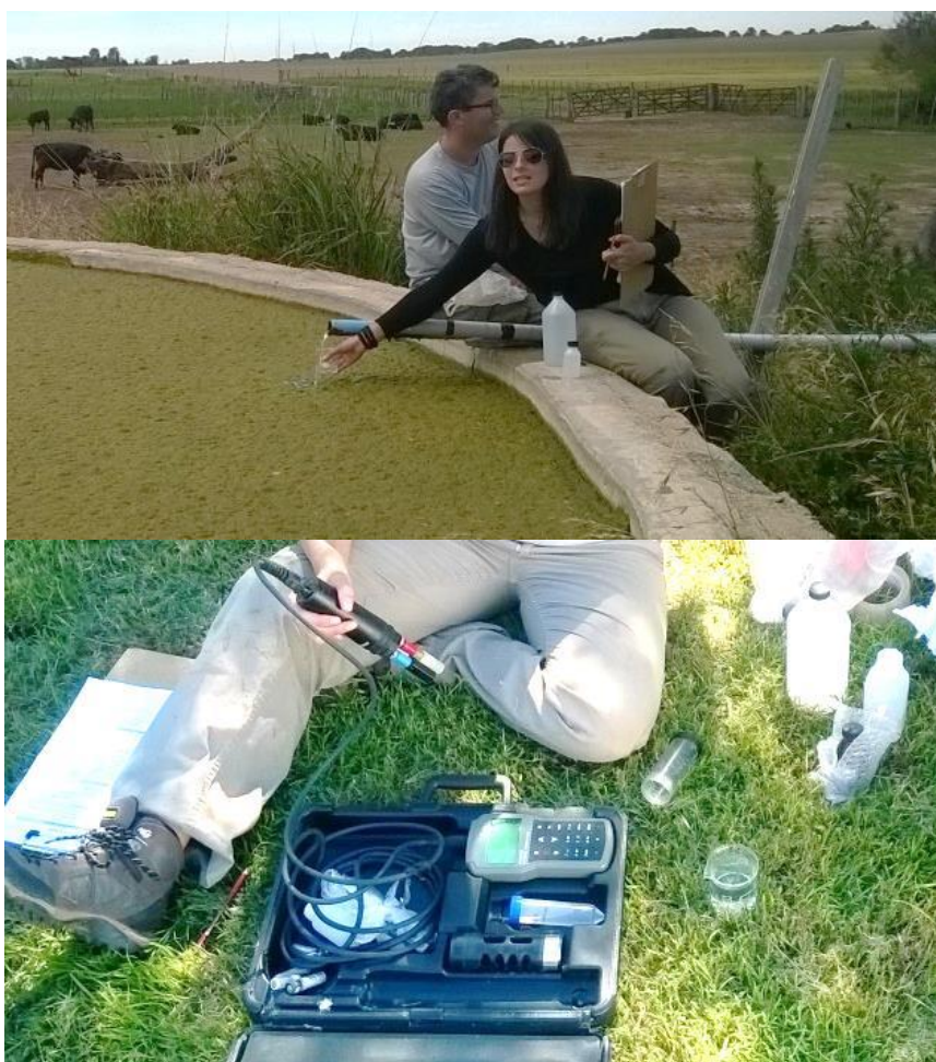
Foto 11. Extracción de muestras (arriba) y medición in situ de parámetros fisicoquímicos (abajo).
