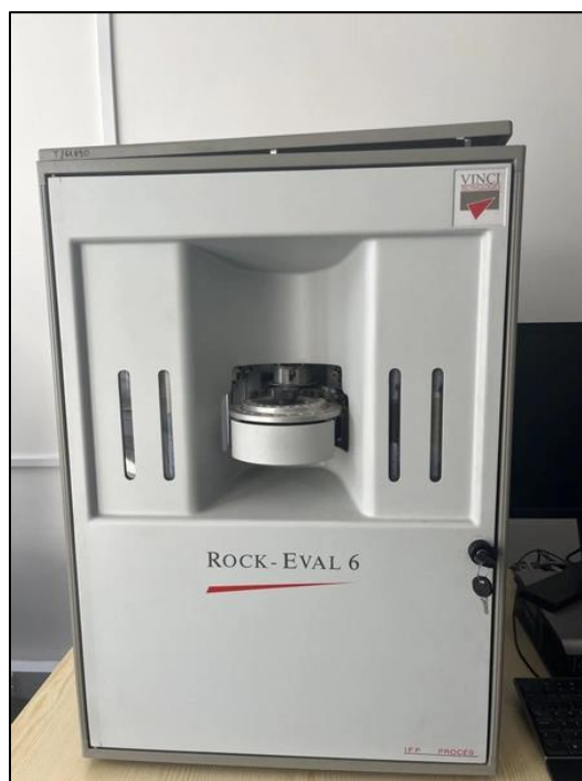
Figura 2.6. Equipo de pirólisis Rock Eval 6 Turbo en los laboratorios de Y-TEC S.A.
