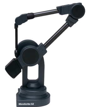
Figura 4.5. MicroScribe empleado en la digitalización de landmarks .
