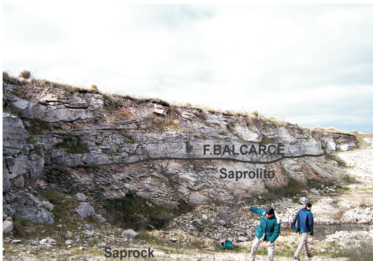
Figura 6. Cantera Estancia Santa María, Chillar. El nivel arcilloso en explotación corresponde al saprolito. El saprock constituye la base de explotación de la cantera.
