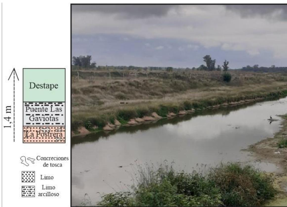
Figura 13 columna esquemática del perfil observado y sus formaciones integrantes.
