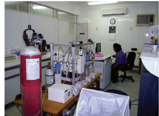
f: Espectrómetro de masas Delta V advantage del laboratorio NEG-LABISE.
