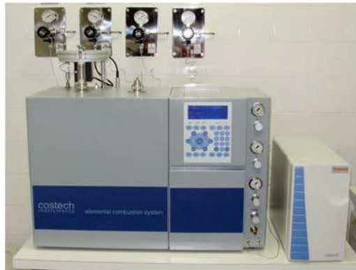
e: Espectrómetro de masas ECS4010 Elemental Combustion System del laboratorio NEG-LABISE.
