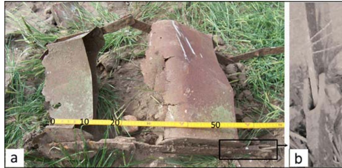
Figura 7. a, Cangilones semienterrados; b, Detalle de la articulación de la cadena de cangilones
