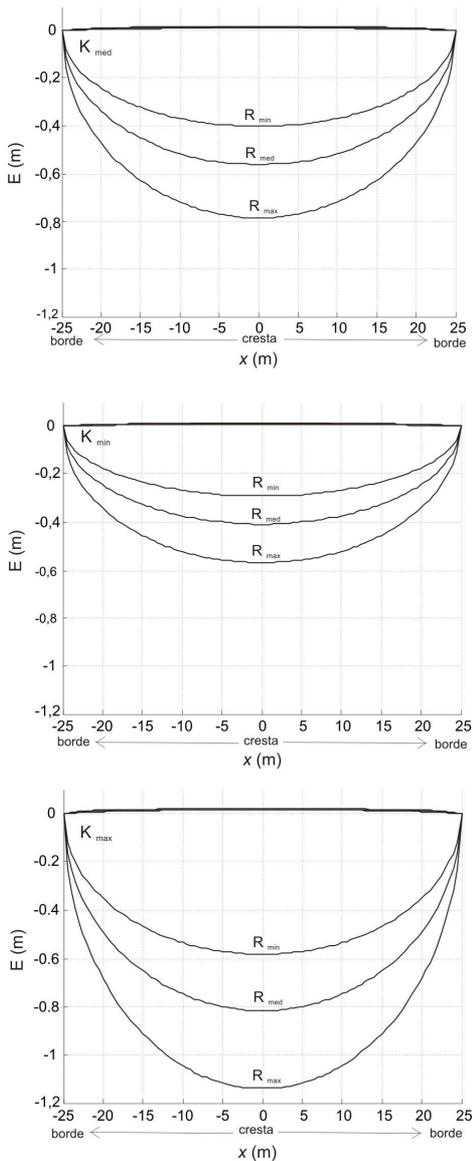
**Figura 5.** Estimación de la variación del espesor de las lentes de agua dulce en un cordón de 50 m de ancho para valores de conductividades hidráulicas medias ( $K_{med}$ ), mínimas ( $K_{min}$ ) y máximas ( $K_{max}$ ), y para valores de recarga media ( $R_{med}$ ), mínima ( $R_{min}$ ) y máxima ( $R_{max}$ ).
