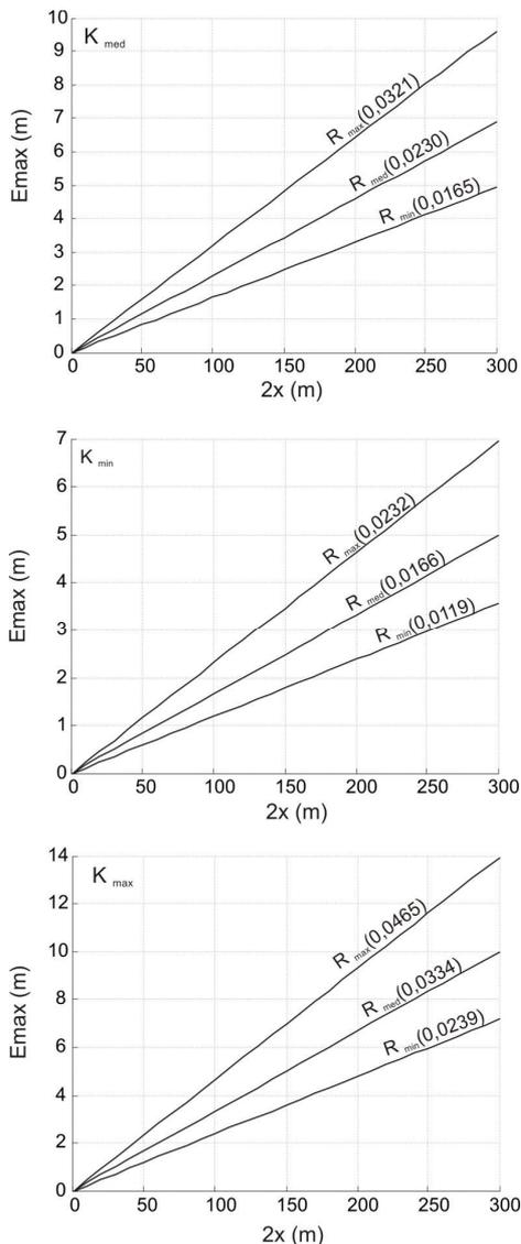
**Figura 3.** Estimación de la variación del espesor máximo ( $E_{max}$ ) de las lentes de agua dulce en función del ancho del cordón de conchilla para valores de conductividades hidráulicas medias ( $K_{med}$ ), mínimas ( $K_{min}$ ) y máximas ( $K_{max}$ ), y para valores de recarga media ( $R_{med}$ ), mínima ( $R_{min}$ ) y máxima ( $R_{max}$ ). Entre paréntesis se indica el valor de las pendientes de las rectas.
