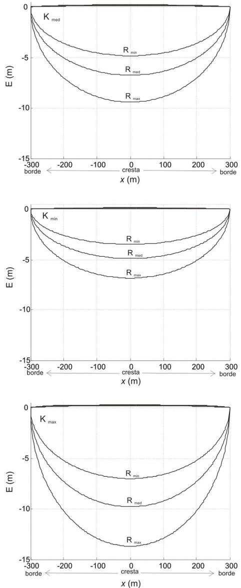
**Figura 4.** Estimación de la variación del espesor de las lentes de agua dulce en un cordón de 600 m de ancho para valores de conductividades hidráulicas medias ( $K_{med}$ ), mínimas ( $K_{min}$ ) y máximas ( $K_{max}$ ), y para valores de recarga media ( $R_{med}$ ), mínima ( $R_{min}$ ) y máxima ( $R_{max}$ ).
