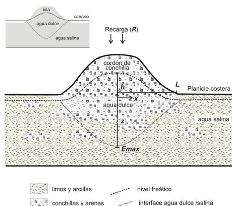
**Figura 2.** Esquema de un corte transversal de un cordón de conchilla indicando las variables consideradas en el modelo. En el extremo superior izquierdo se muestra un esquema resumido para islas oceánicas.
