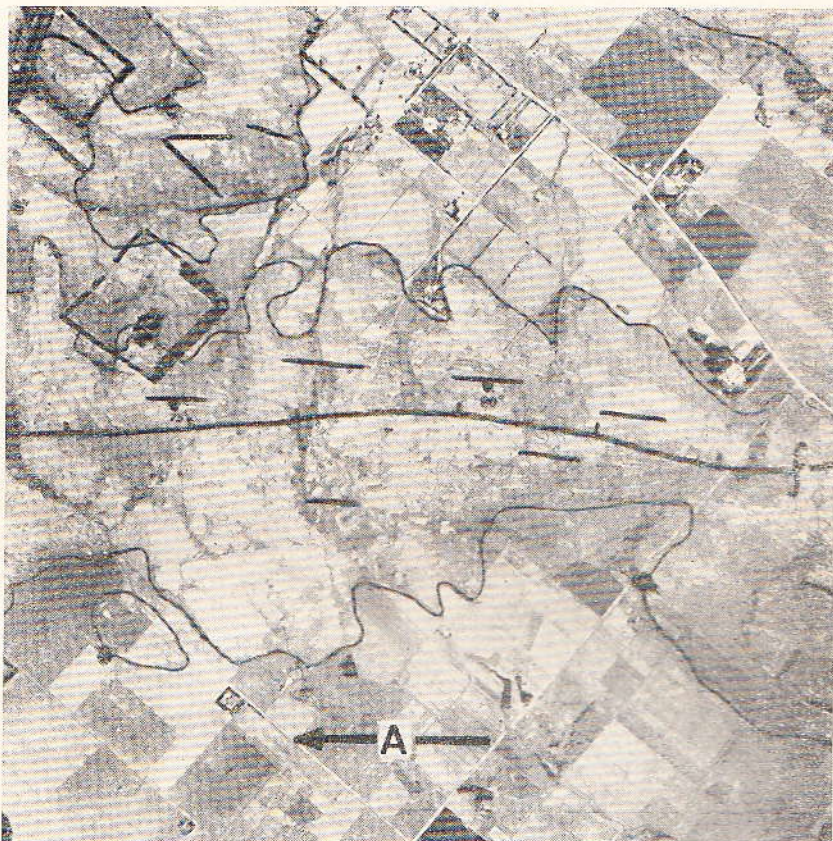
Fig. 3. — Aerofoto correspondiente a la zona de la sierra del Tigre. Se observa claramente la foliación regional, apretada, de rumbo aproximado E-W. Al norte de la gran falla E-W, metamorfitas de grano fino; al sur, rocas granitoides con intercalaciones menores de metamorfitas de grano fino. En el ángulo NW de la foto se observa la intersección de dos líneas estructurales una W-E y otra NW-SE dando lugar a la formación de figuras rómbicas. Bordes verticales hacia el N (arriba). Ib. para figs. 4 y 5.
