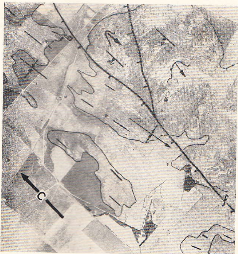
Fig. 5. — Sector del Cerro La Ribullia. Dominio tectónico C. En los afloramientos se observan estructuras megascópicas antiformentes, con hundimiento de ejes al SE. Separado por la falla NW-SE, hacia el oeste se destaca una estructura sinforme de eje casi horizontal. Escala aproximada 1 : 40.000.
